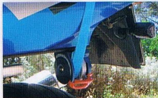
• Una volta posta in tensione la cinghia, la leva si ripiega in posizione di riposo.
